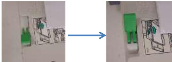
Imagen 16: Cambia de posición la palanca en el Bypass Tray.
